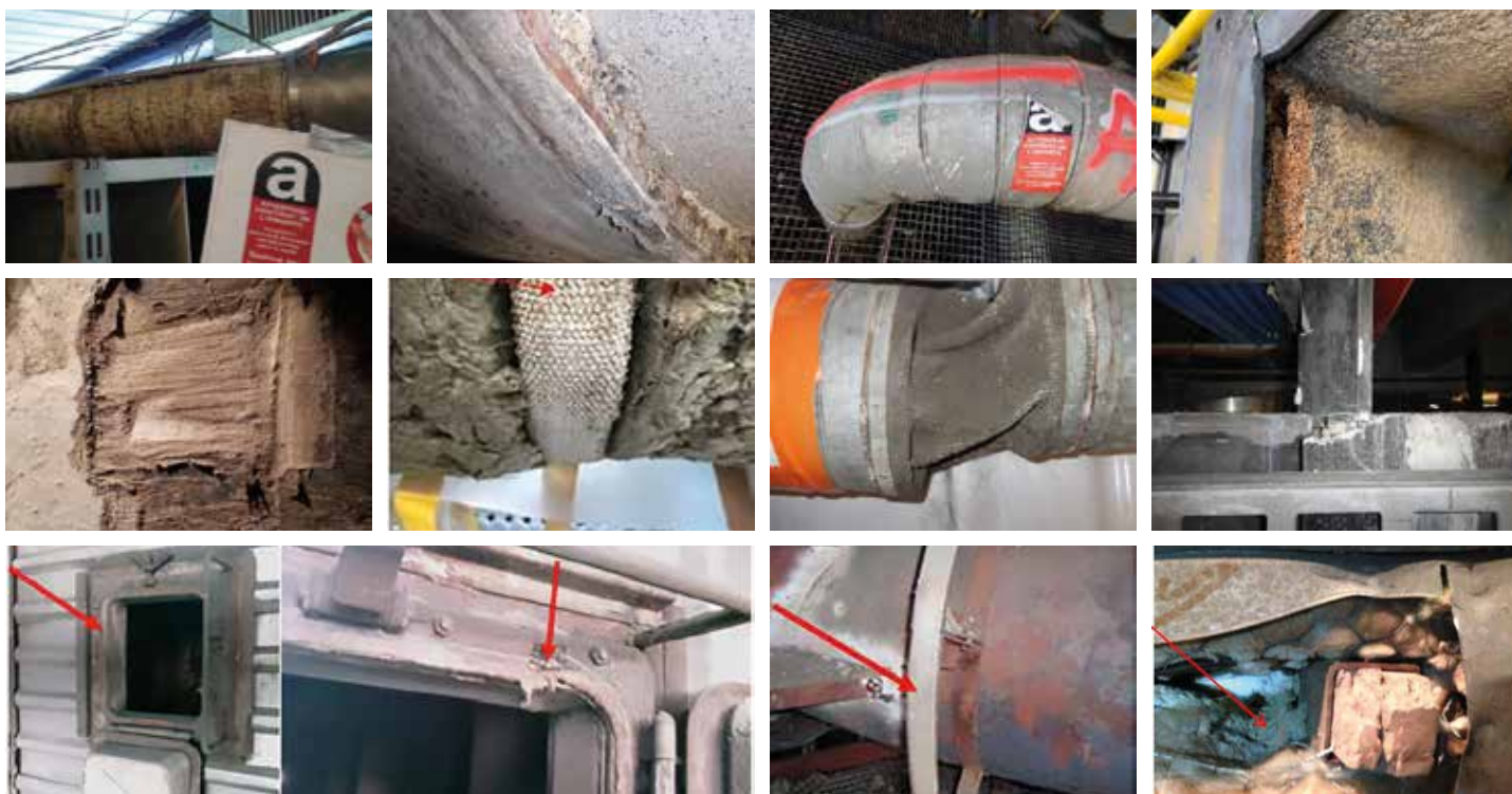
Boîte froide : remplie d'amiante.
